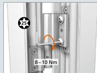
**Exzenterbuchsen gemäß Darstellung einsetzen.**
