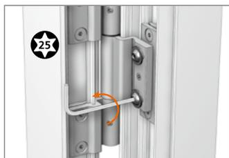
**Befestigungsschrauben des Flügelbandteils entfernen.**
