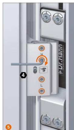
Klemmschrauben festziehen, 1,5 bis 2 Nm.
