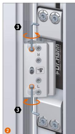
Beide Sicherungsschrauben bis Anschlag lösen.
