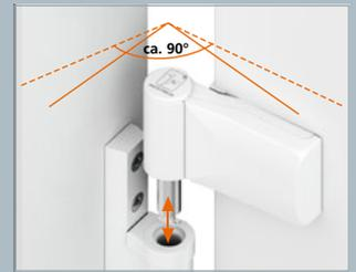
Gondage et dégondage de la porte avec un angle d'ouverture de 90°. Si nécessaire, expulsez l'axe.
