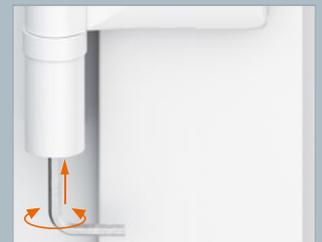
Réglage en hauteur (réglage vertical) continu à partir de la position zéro. Soulever + 4 mm, Abaisser - 3 mm.
